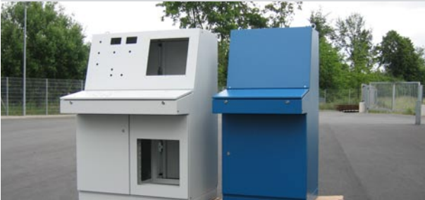
Bedienpulte Baustahl lackiert
